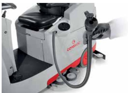
Il tubo di riempimento del serbatoio soluzione (optional) è pratico e di lunghezza adeguata per raggiungere direttamente un rubinetto dell'acqua. In alternativa è disponibile un sistema di riempimento rapido con galleggiante per ridurre i tempi passivi.
