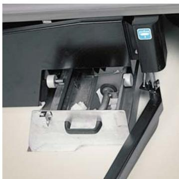
I rifiuti vengono raccolti dalla spazzola cilindrica in un apposito e capace cassetto. L'operazione di svuotamento si compie facilmente, sfilando dalla parte inferiore della fiancata della macchina, tramite delle guide con cuscinetti
