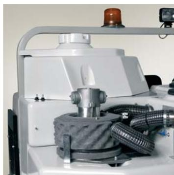
Motore d'aspirazione facilmente accessibile grazie alla semplicità di smontaggio del carter di protezione
