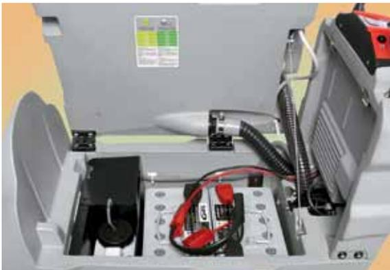
Le batterie e la tanica del detergente sono alloggiati nel vano ricavato nel serbatoio soluzione.
