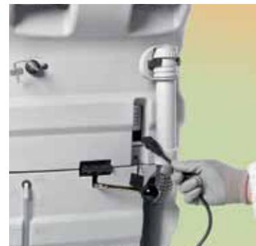
Su richiesta le lavasciuga pavimenti Abila (versioni BT) si possono avere anche con il pratico caricabatterie a bordo. Per la ricarica della macchina basta infatti collegarsi con il cavo in dotazione ad una tradizionale presa di corrente semplificando la manutenzione a fine ciclo di lavoro
