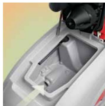
Il particolare design conferito al serbatoio di recupero e il tubo di scarico di grande diametro consentono di svuotare completamente l'acqua sporca raccolta senza lasciare alcun tipo di residuo **IN TEMPI MOLTO RAPIDI, e senza interventi manuali**
