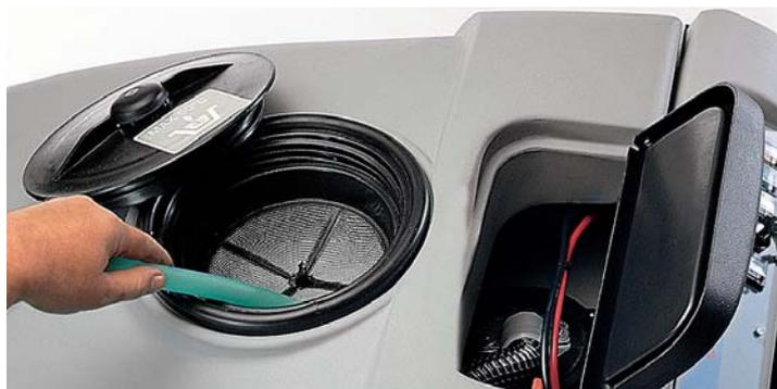
I serbatoi soluzione e di recupero, costruiti in polietilene rotazionale, sono robusti e resistenti agli urti ed alla corrosione. Il serbatoio della soluzione detergente è collocato sulla parte superiore della macchina e ciò rende più efficace il flusso dell'acqua sulle spazzole perché è costante. Esso si carica attraverso un'ampia apertura e contiene rispettivamente 75 litri in Omnia 26 e 105 litri nel modello Omnia 32
