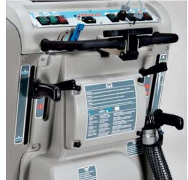
Nella parte posteriore vi sono le leve dei comandi per il sollevamento e la regolazione dei gruppi di lavoro, le leve dei freni di servizio e di stazionamento. Inoltre vi sono due scarichi del serbatoio di recupero di cui uno di ampia sezione per facilitare la pulizia interna
