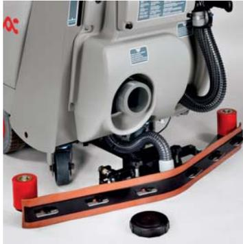
Il gruppo tergilavaggio è oscillante per seguire la macchina in ogni situazione in modo da ottenere una perfetta asciugatura. La regolazione del tergilavaggio viene eseguita senza utensili direttamente dall'operatore
