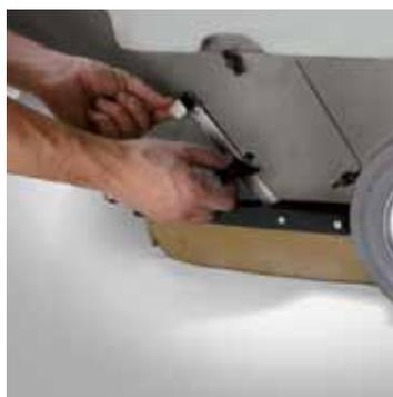
La regolazione dell'altezza della spazzola centrale avviene facilmente senza l'uso di utensili
