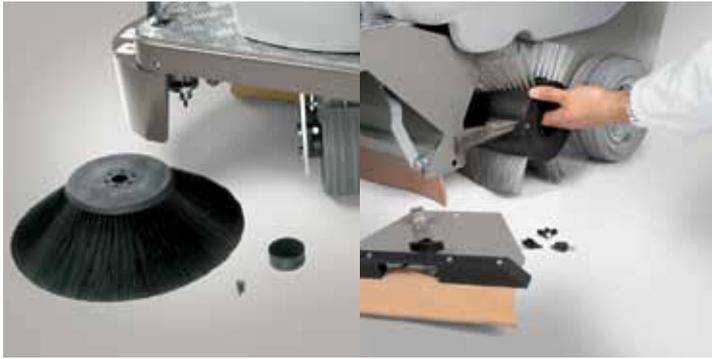
Le spazzole laterale e centrale si sostituiscono facilmente senza l'uso di utensili
