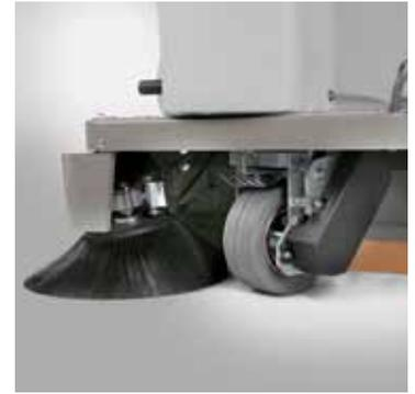
Il sistema a motoruota anteriore garantisce un'ottima manovrabilità durante il lavoro
