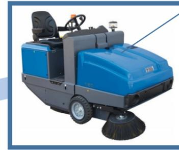
Offerta di una gamma completa di spazzatrici professionali **Isal**, con **operatore a terra** per interventi su piccole superfici, con **operatore a bordo** per interventi su ampi spazi, e **urbane** per raccogliere rifiuti solidi e aspirare le particelle più fini (polveri PM10).
