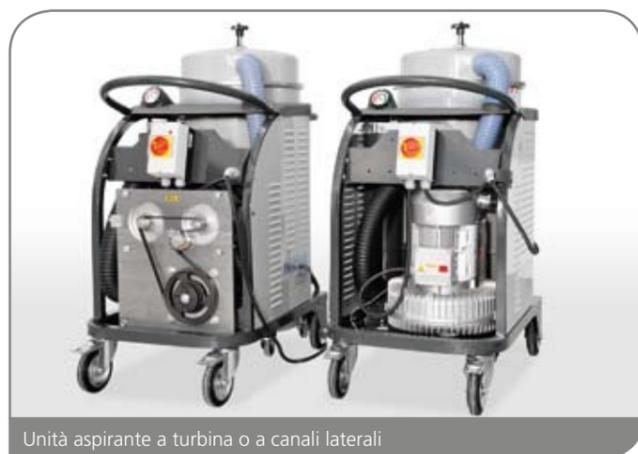
Unità aspirante a turbina o a canali laterali
