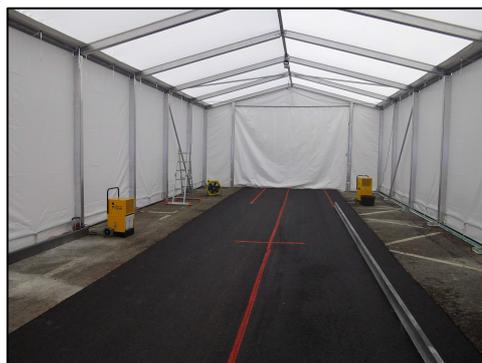
Il materiale di test doveva essere raccolto dalla spazzatrice ad una velocità costante di avanzamento di 4 km/ora.
