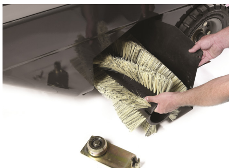
Il sistema 'No Tool™' consente un accesso rapido e senza l'uso di attrezzi alla spazzola principale per la manutenzione
